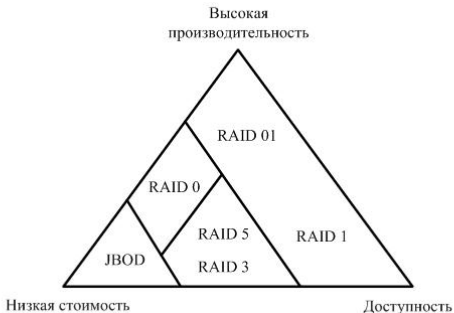
Рисунок 1 – Уровни RAID массива.
